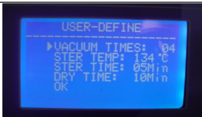
Lorsqu'on déplace le curseur sur cette option, l'utilisateur peut appuyer sur « UP » ou « DOWN » pour modifier le paramètre. En appuyant sur « OK », le curseur se déplace sur l'option suivante.
